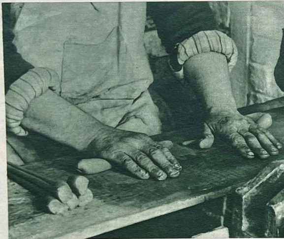
En-dessous : Il prend de la terre malaxée et la roule à la main.
